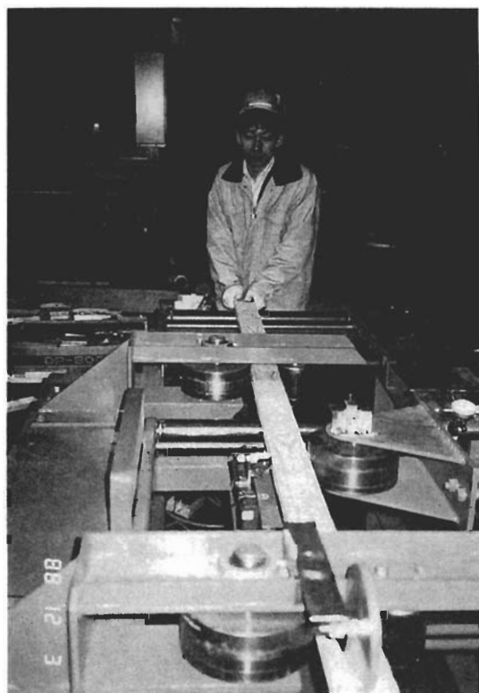
図4-2 AEグレーダーの3点曲げ部分
