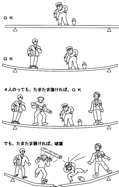
図2.8 足場板の破壊
