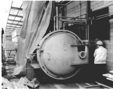
写真4 高周波加熱減圧乾燥機
