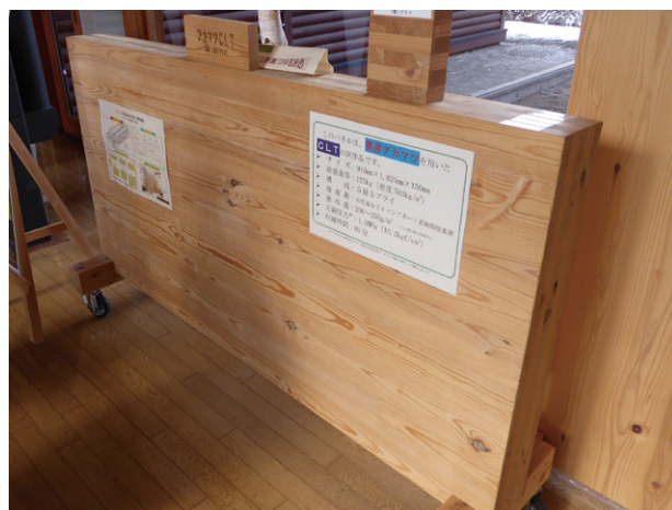
写真3 岩手県林業技術センターに展示されているアカマツCLTの試作品
