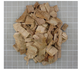
写真2 製造した木材チップ 樹種:クヌギ
