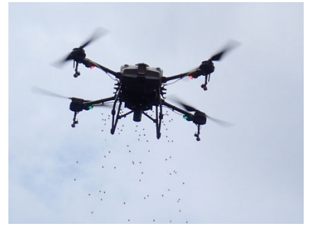
写真 5-16 UAV による種子ペレットの播種
