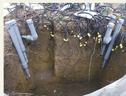
土壌中の水と熱の動態を観測するための機器
