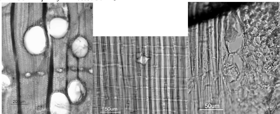
図 4 単板-1の光学顕微鏡写真。左:同心円状に配列した軸方向樹脂道(木口面)。中:放射組織の異形細胞中の結晶(柁目面)。右:軸方向柔組織の異形細胞中の結晶(板目面)。
