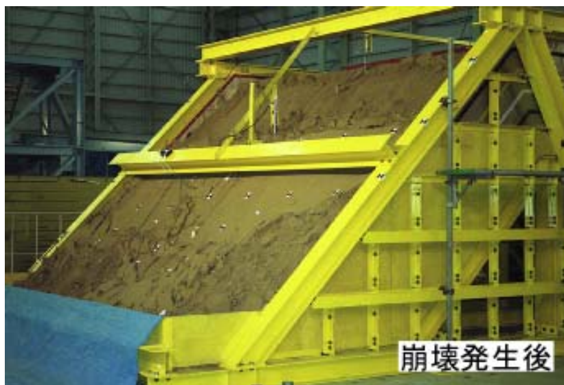
写真－4 実験による斜面崩壊
