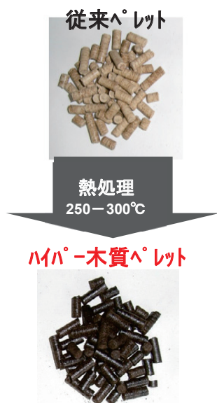
図1 従来ペレット(上)と ハイパー木質ペレット(下)
