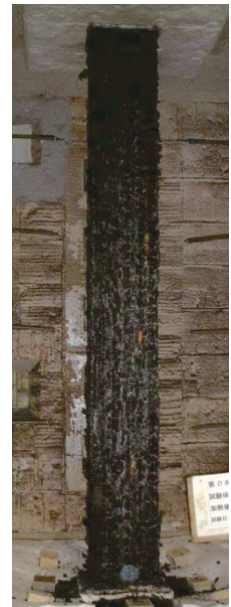
耐火集成材断面図と試験後の様子
