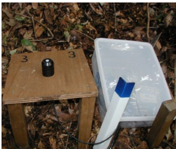
林床における日射量と林床可燃物の含水率の測定の様子
