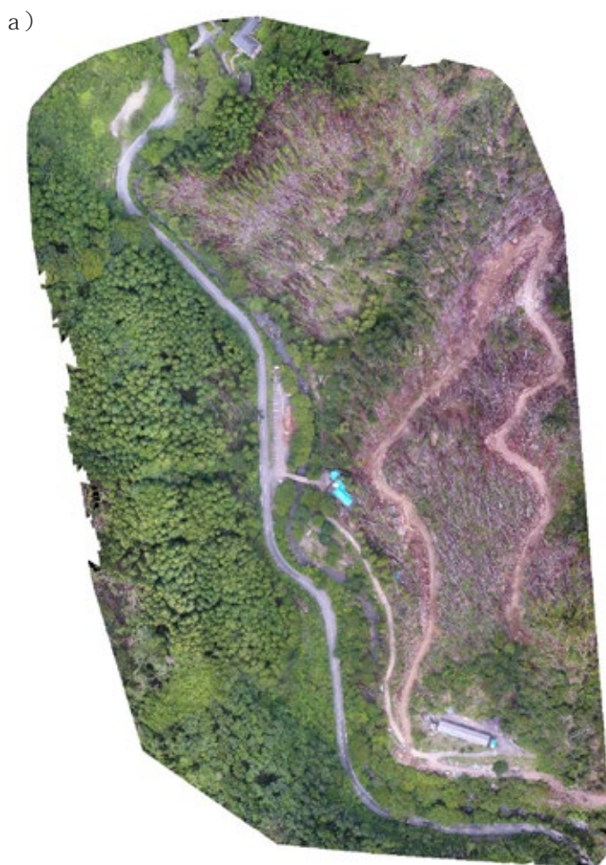
図3 a) 風倒被害林分の UAV 画像によるオルソモザイク画像 中央の矢印は、15 ページ写真 1 の撮影場所、方向を示している b) 風倒被害林分の UAV 画像による DSM (デジタル表面高モデル) c) SfM の解析結果の表示例 オルソモザイク画像と DSM を組み合わせることで三次元表示が可能 三次元表示の上空にある画像は、UAV で撮影した位置とそのサムネイル画像
