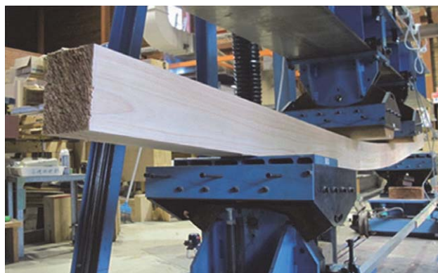
写真 2 コウヨウザン平角材の曲げ強度試験
