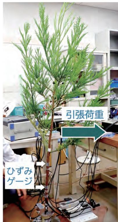
図2 スギを用いた試験の様子
