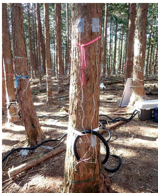
図3 立木に風力測定センサーを取り付けた様子
