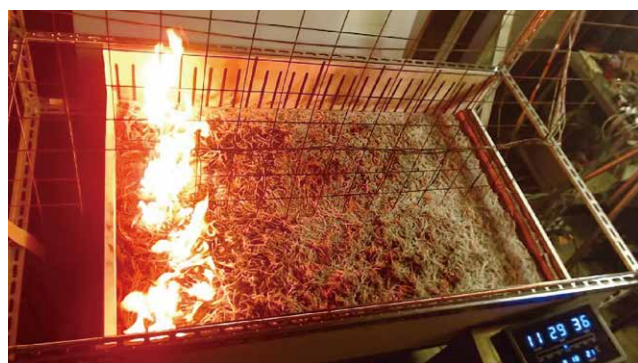
図2 林床可燃物の燃焼試験
