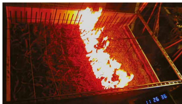
図2 燃焼実験を行い、延焼速度を測定
