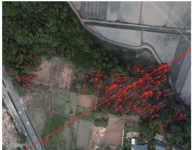
写真 3 2012 年茨城県常総市からつくば市にかけて発生した竜巻による森林の被害 線が竜巻の推定経路、矢印が倒木の方向を表している。（矢印が中心線に向かっており、収束性が見られることがわかる。）
