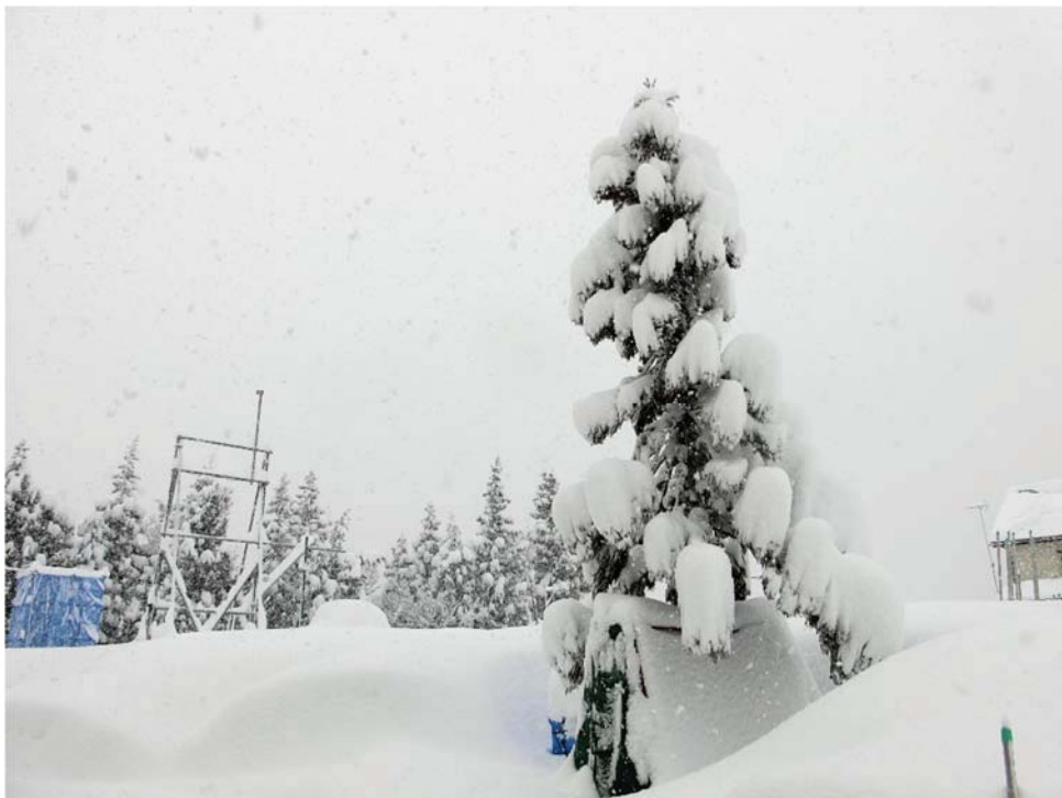
森林総合研究所十日町試験地でのスギの着雪量の野外観測の様子
