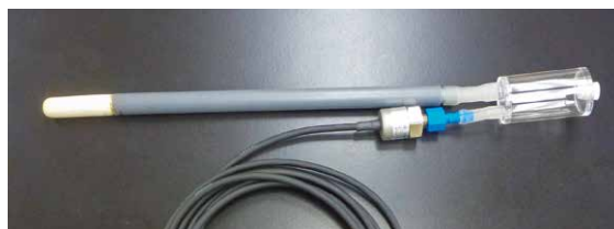
写真 1 現在の圧力センサ式テンシオメータ（部材から自作したもの）
