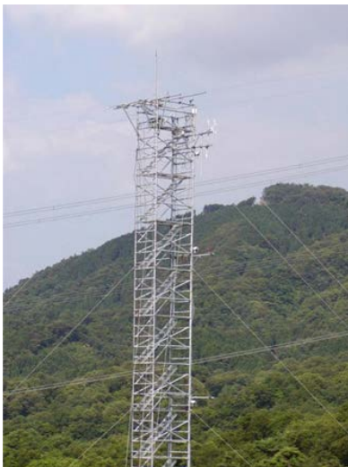
森林と大気との間を 移動するエネルギー と二酸化炭素を測定 するための気象観測 タワー Meteorological tower for measurement of CO 2 and energy flux between forest and atmosphere
