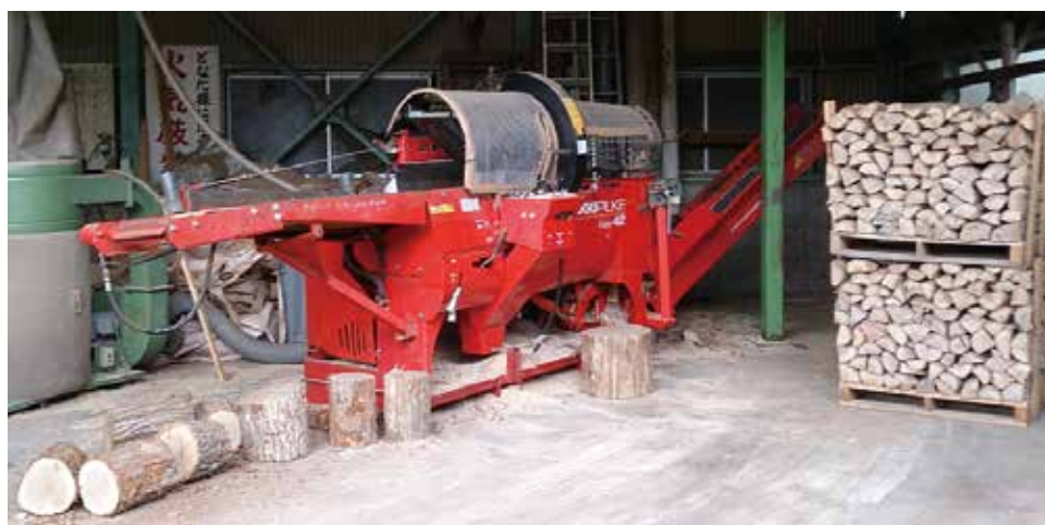
写真 1. 大型薪割機による薪の製造
