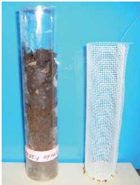
写真 土壌コアサンプリングによって採取された土壌円筒試料（左）とイングロースコア（根なし土壌コア）法で用いるメッシュ円筒（右）
