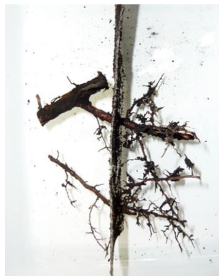
写真2 メッシュシート設置1年後に通過したスギの根
