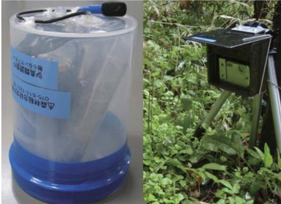
写真2 自動録音装置（左）と自動撮影装置（右）の一例
