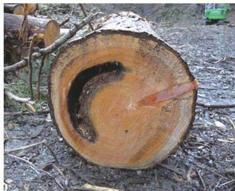
写真 スギ大径木の辺材腐朽被害
