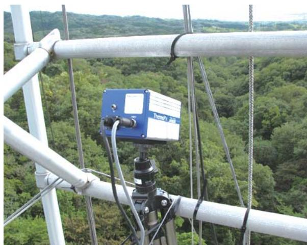
写真1 気象タワーに設置された赤外線サーモグラフ
