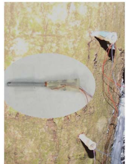
写真1 グラニエ法のセンサーと設置状況 (上側のセンサーは保護管内にニクロム線が巻かれている)
