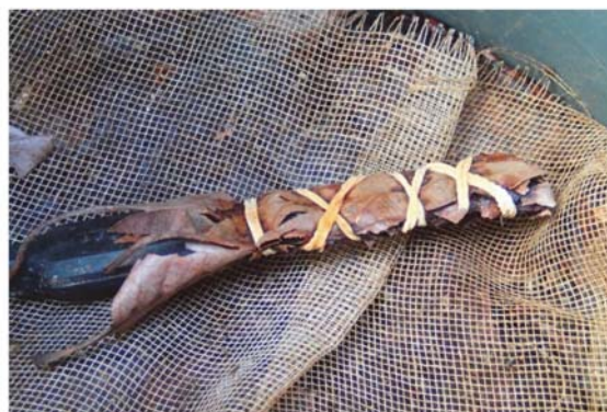
写真3 落葉含水比センサー
