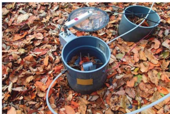
写真2 落葉分解呼吸速度測定チャンバー
