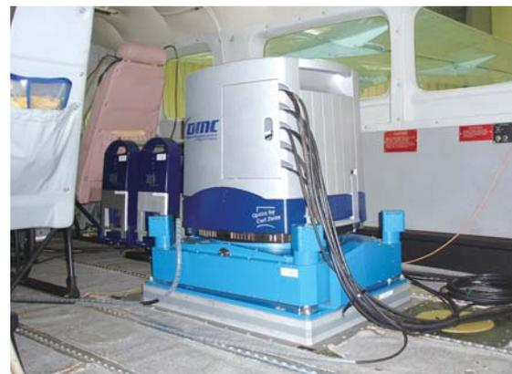
写真 航空機内の空中写真撮影用デジタルカメラ
