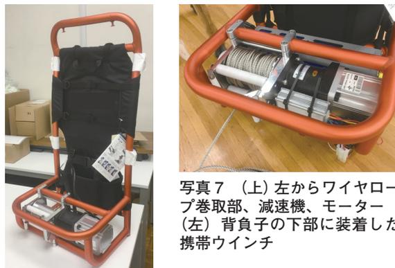
写真7 (上) 左からワイヤロープ巻取部、減速機、モーター (左) 背負子の下部に装着した携帯ウインチ
