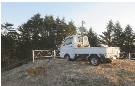
写真6 軽トラックに搭載した簡易架線でシカ模型を引き上げている様子
