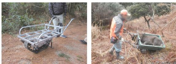
写真4 電動クローラ型一輪車 写真5 捕獲現場の斜面での使用状況
