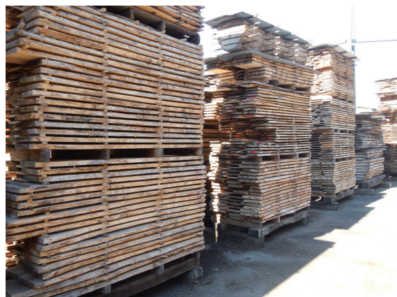
写真4 広葉樹板の乾燥工程の一部
