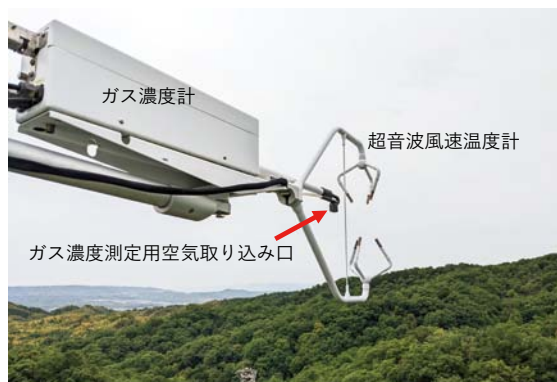
図2 渦相関法のための超音波風速温度計とガス濃度計
