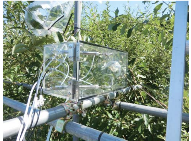
コナラの葉から放出されるイソプレンを測定する自動葉群チャンバー
