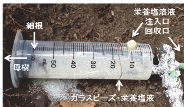
写真 1 現場に設置した根滲出物回収シリンジシステム
