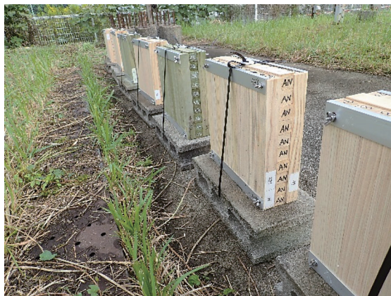
写真1 CLT 耐久性評価試験の様子
