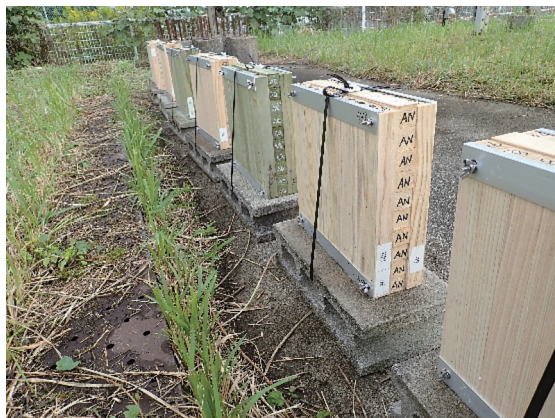
写真1 CLT 耐久性評価試験の様子
