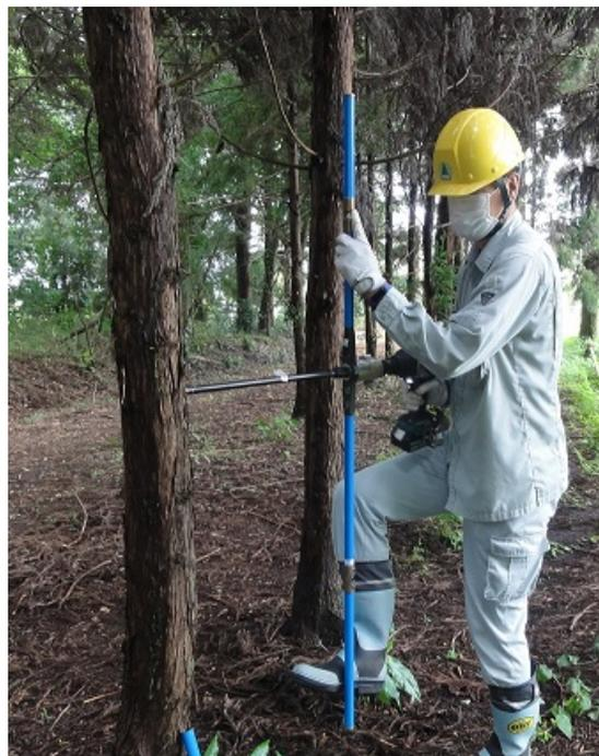
写真1. スマートボーラーでの試料採取の様子
