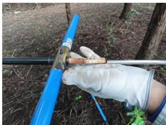
写真2. スマートボーラーで採取した試料
