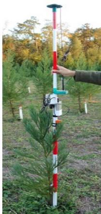
写真1. GNSS 測量用の移動局
