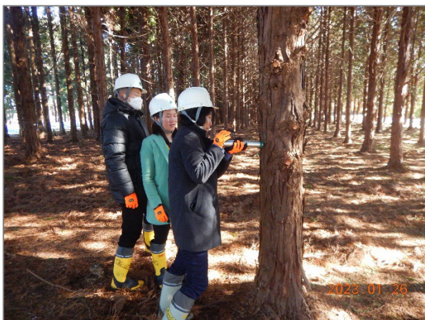
写真3. ピロディンを使用している様子
