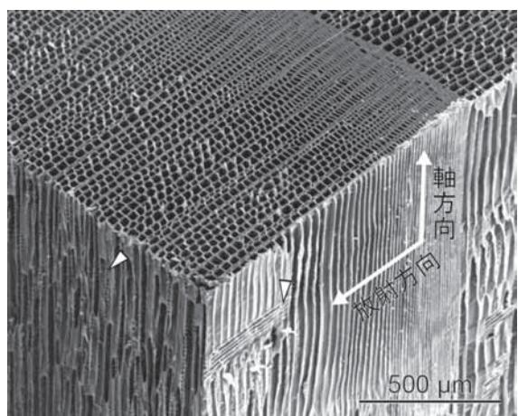
図. スギ木部組織のSEM写真（中田了五氏提供）
