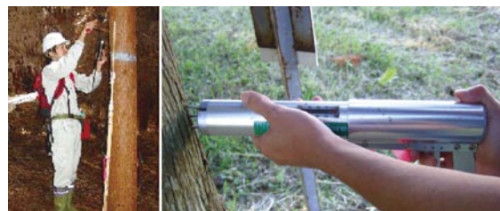
写真 (左)応力波伝播速度の測定、(右)ピロディン陥入量の測定
