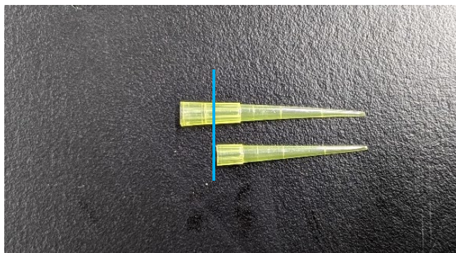
⑦ ピペットチップの根元を、シリンジの口に合うようにカットする。
