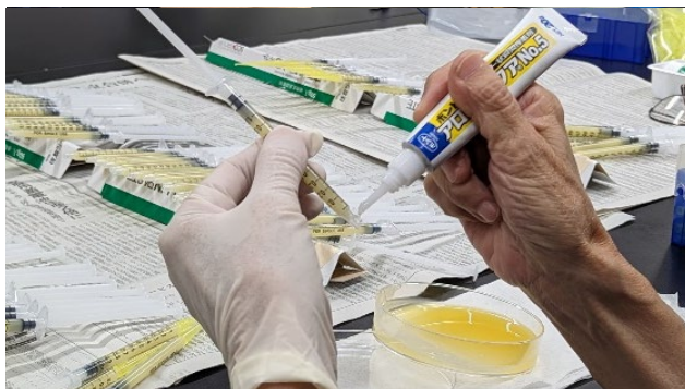
⑧ チップを瞬間接着剤でシリンジの先に接着する。
