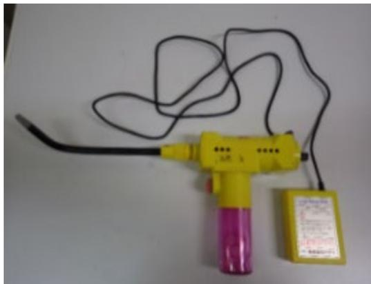
写真4 電池式花粉散布機
