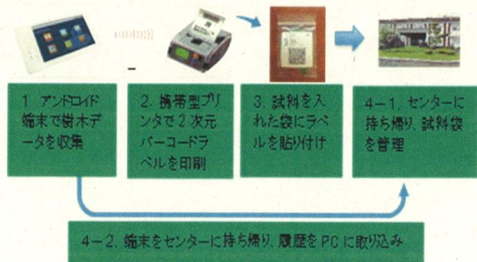
図2 2次元バーコードシステムの概要
