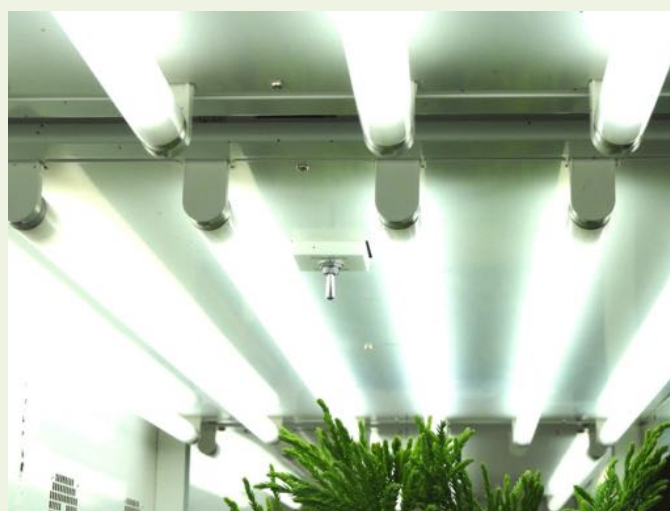
図2 植物工場の光源パネルに全て蛍光灯を取り付けた状態
