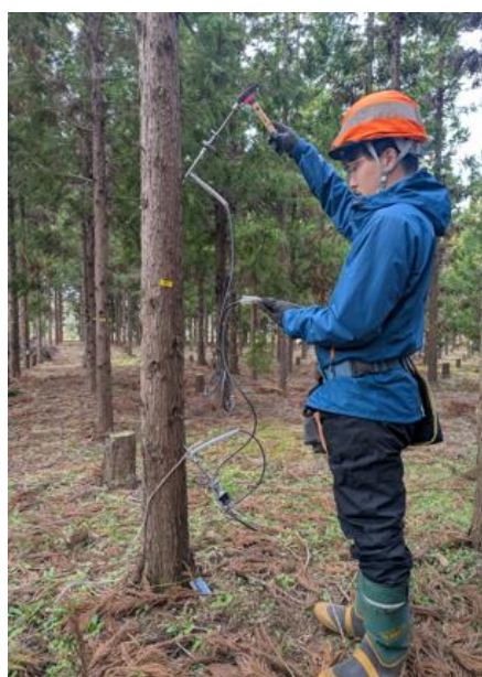
図 立木状態で応力波伝搬速度を測定している様子
