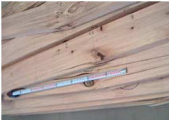
強度試験したグランディスの材 死節が目立つ
