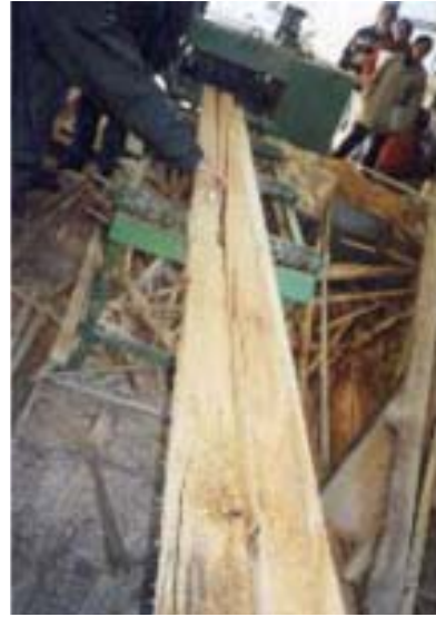
グランディス製材 成長応力による割れ
