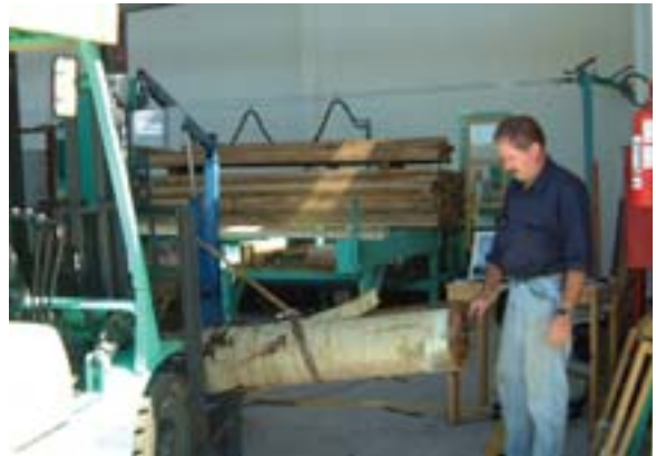
タッピング法による丸太の ヤング率の測定
