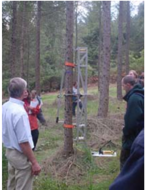
写真-5 生立木樹幹曲げ試験（いわゆるぶら下がり法）の機器
