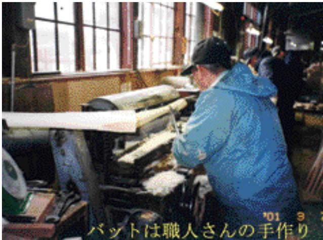
写真 - 1 北海道産アオダモを使用したバットの製造
