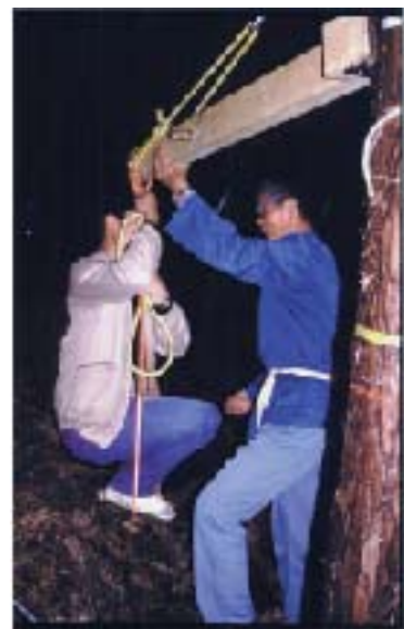
ぶら下がり法による立木のヤング率の測定
