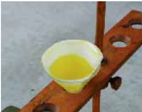
写真 - 5 濾紙を用いた虫媒花花粉の捕集
