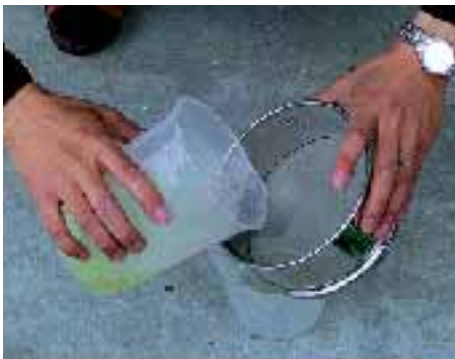
写真 - 4 有機溶剤を用いて収集した虫媒花花粉の篩を用いた精選
