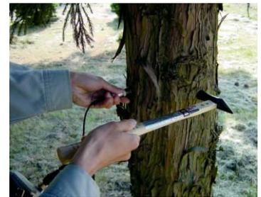
写真2 横打撃共振法による測定
