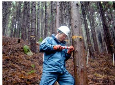
写真：検定林内での容積密度簡易測定の様子
